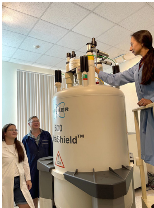
Лаборатория Радиоспектроскопии. Слева направо: м.н.с. С. А. Кондрашова, с.н.с., к.х.н. В. В. Сякаев, вед. инж. Г. Т. Файзрахманова. Идёт работа на ЯМР-спектрометре Avance-600.
