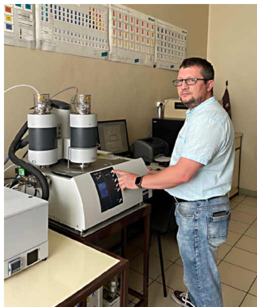
Лаборатория Физико-химического анализа. А. Р. Хаматгалимов – д.х.н., заместитель директора по научной работе ИОФХ, проводит исследования на дифференциальном сканирующем калориметре с термогравиметрическим анализатором.
