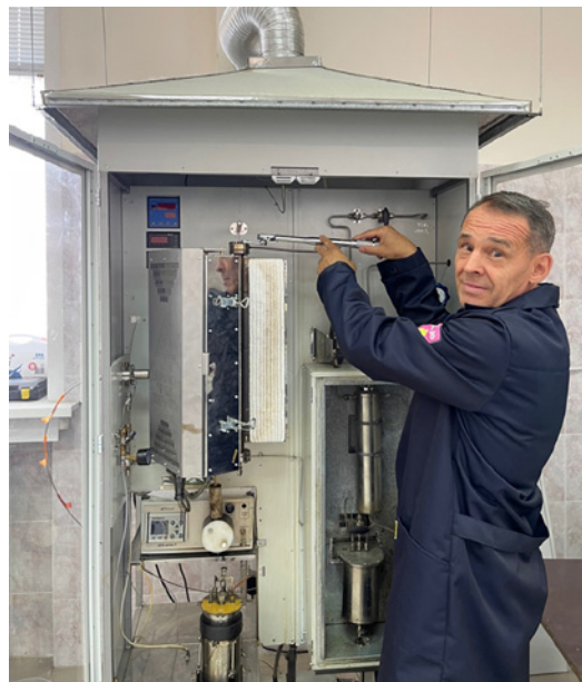
Косачёв Игорь Павлович, к.х.н., с.н.с. лаборатории Переработки нефти и природных битумов проводит моделирование процессов термoкрекинга тяжёлой нефти на проточном автоклаве.
