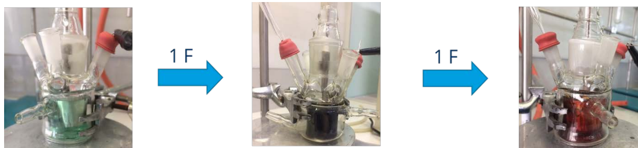
Рисунок 16 - Изменение цвета раствора электролита в течении электролиза
