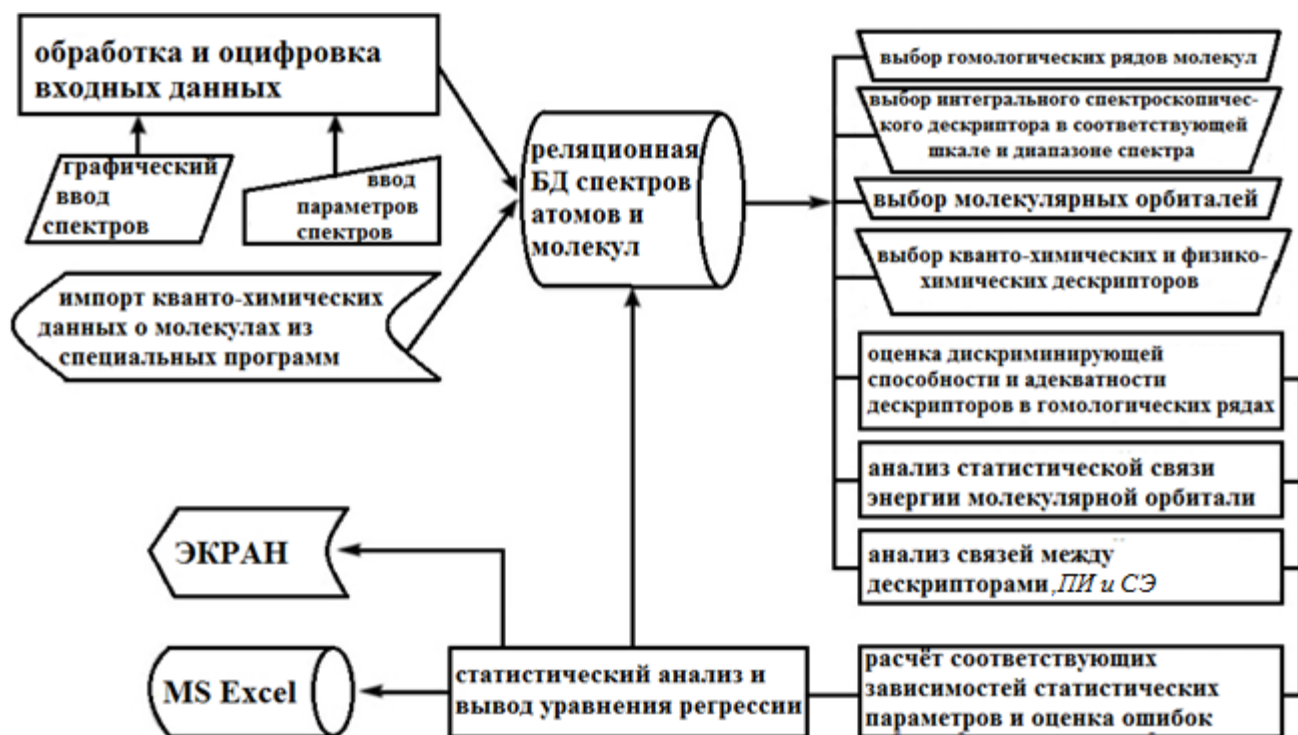
Рисунок 8 – Блок-схема работы программы «ФЕНИКС-ЛД»
