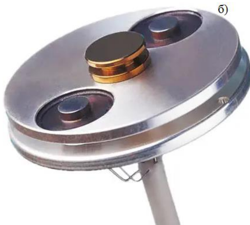
Рис. 2.4. Дифференциальный сканирующий калориметр Netzsch DSC 204 F1 Phoenix (а) и \tau -сенсор (б).
