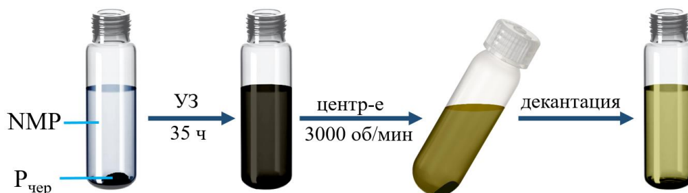
Рисунок 3 – Схематичное изображение жидкофазного расслоения ЧФ с помощью ультразвука. Сделано на основе рисунка из [10].
