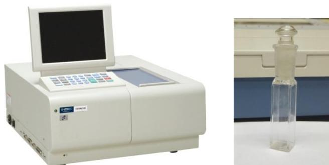
Рисунок II.1. Спектрофотометр Hitachi U-2900 и кварцевая кювета, используемая для кинетических измерений при атмосферном давлении.
