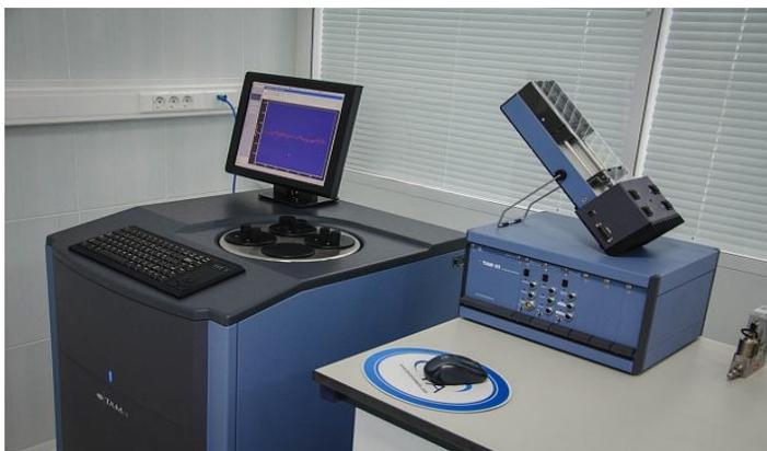
Рисунок II.7. Калориметрическая система ТАМ III (США).
