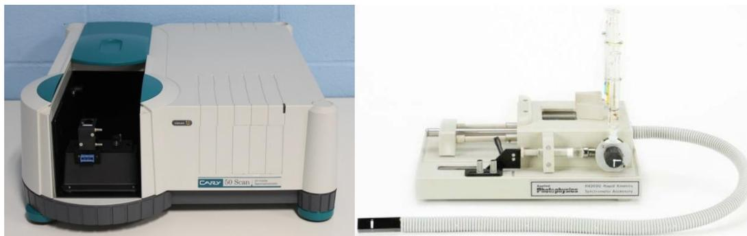
Рисунок II.2. Спектрофотометр Varian Cary 50 Bio (США) с приставкой Applied photophysics «RX2000».
